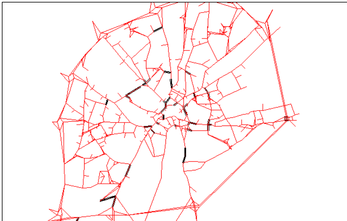
Abb. 5 York Netzwerk mit Kanten auf denen es Stau in der Morgenspitze gibt gemäss der PFE-Analyse (stochastisches Gleichgewicht, ohne Störfallbetrachtung).
